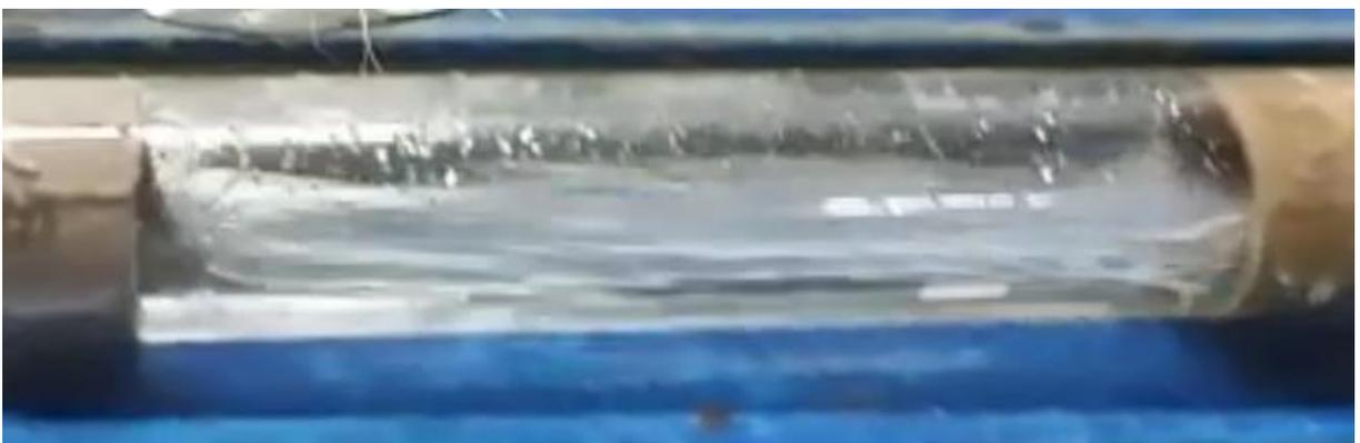
Figura 35 - Escoamento bifásico tipo estratificado, observado à jusante do sistema de medição
