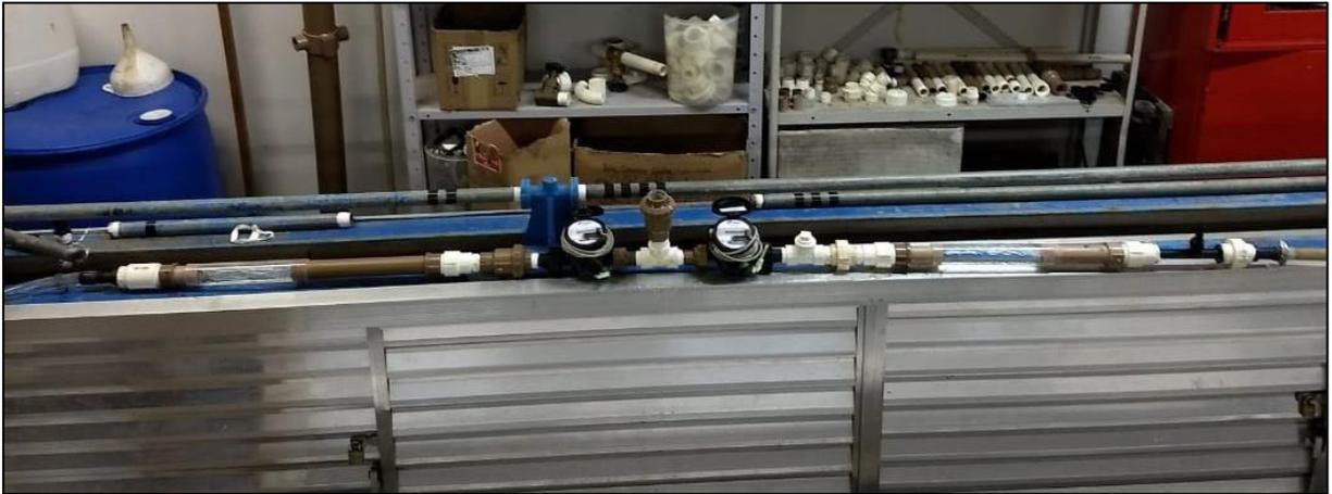
Figura 33 - Aparato para teste com escoamento bifásico
