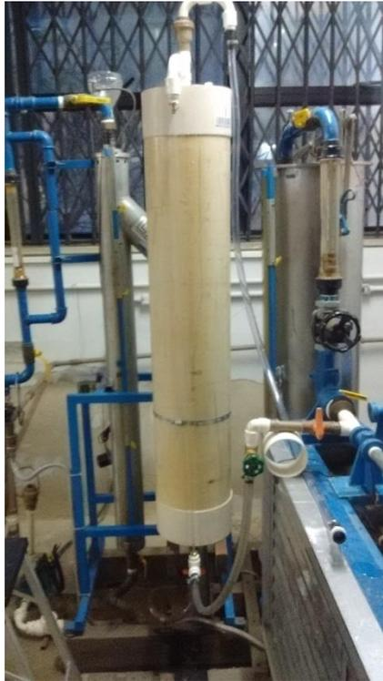
Figura 31 - Reservatório de ar desenvolvido
