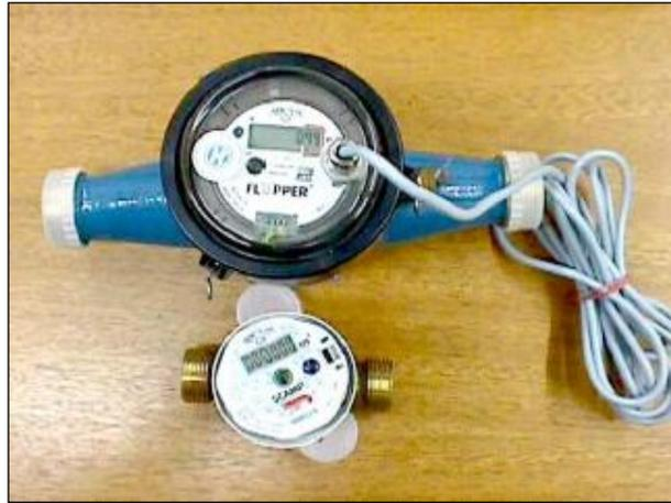
Figura 14 - Hidrômetros eletrônicos
