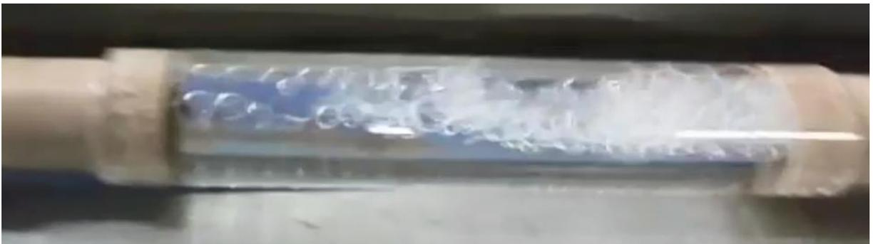
Figura 34 - Escoamento bifásico tipo borbulhado, observado à montante do sistema de medição
