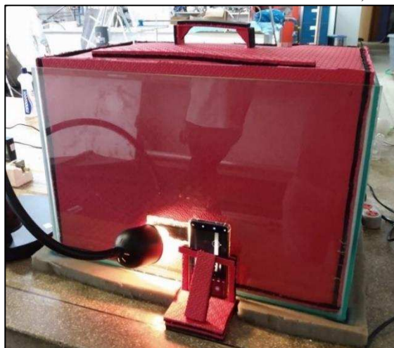
Figura 1 - Reservatório de vidro revestido internamente com EVA, iluminação e filmagem.
