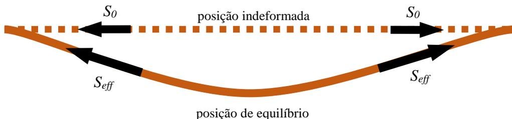
Figura 24: Força axial em vão livre na posição indeformada e de equilíbrio
