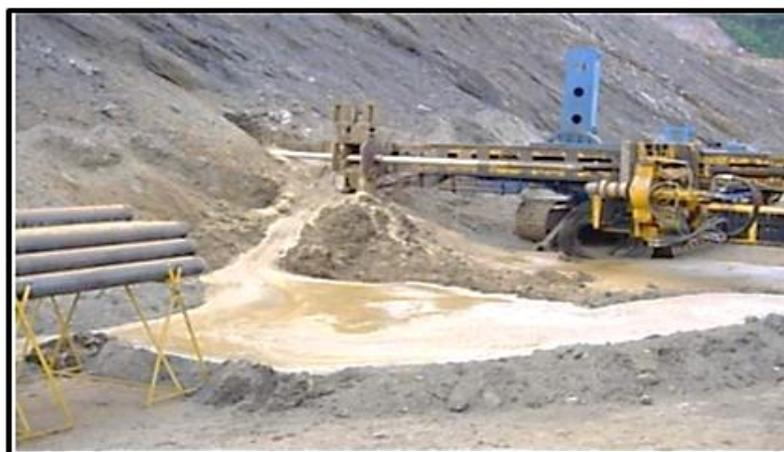
Figura 13 - Perfuratriz realizando um DHP, com limpeza de furo.
