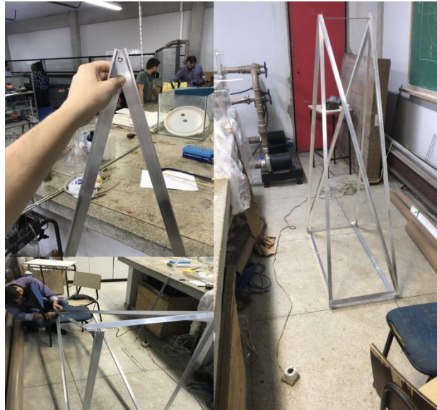
4.19 - Estrutura usada como apoio do canal. Fonte: Elaboração própria (2018).
