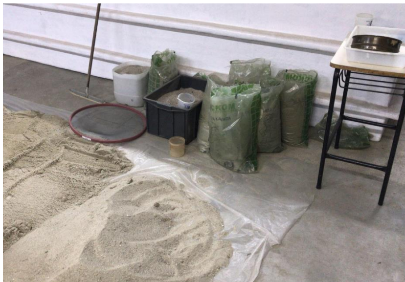
4.11 - Deposito da areia fina e grossa após o peneiramento. Fonte: Elaboração própria (2018).
