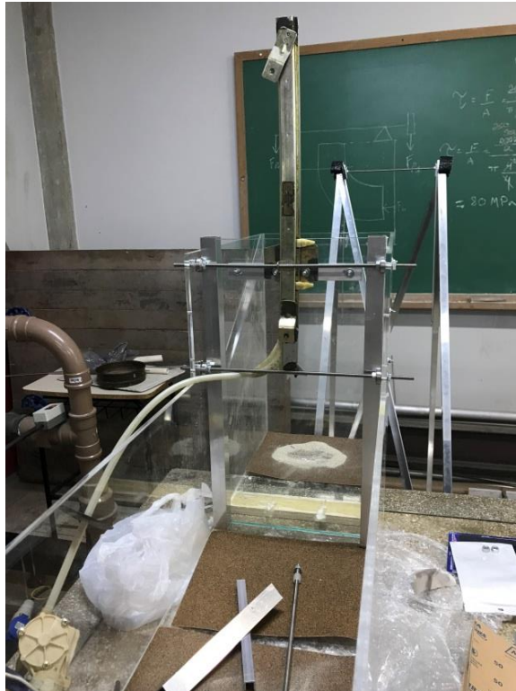
4.16 - Montagem do elevador automatizado para a comporta. Fonte: Elaboração própria (2018).
