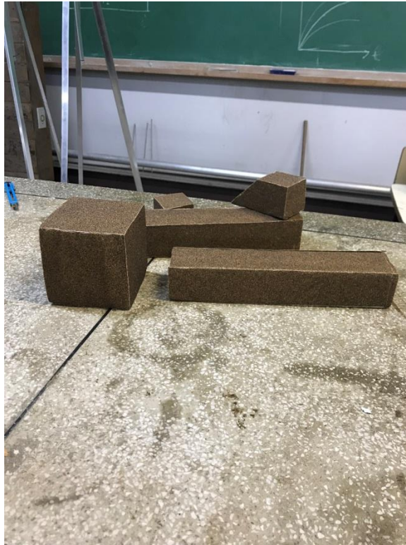
4.18 - Obstáculos com lixa usados nos testes experimentais. Fonte: Elaboração própria (2018).
