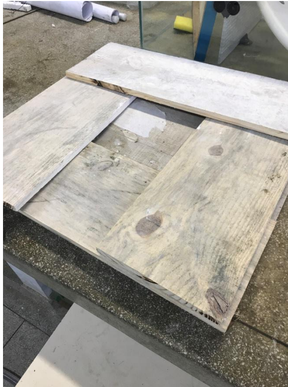
4.21 - Caixa de madeira para o depósito do fluxo de areia do canal. Fonte: Elaboração própria (2018).
