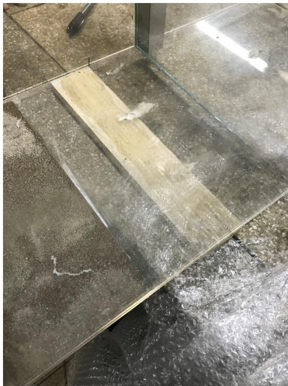
4.20 - Apoio de multiuso para o canal frente a variações de inclinações.
